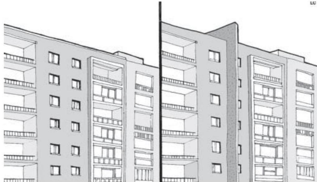
Separação por parede corta-fogo
